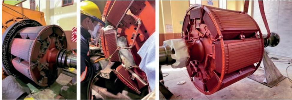
Antes de su mantenimiento se verificó la condición de los polos y anillos rozantes mediante pruebas eléctricas, se realizaron también trabajos de mantenimiento en el estator eliminando material contaminante, además de inspecciones y pruebas eléctricas para verificar la condición del estator.
