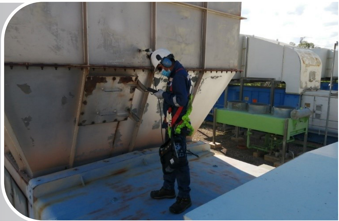
Monitoreo de Gases de Combustión Fuentes Fijas (Central Termoeléctrica Valle Hermoso)
