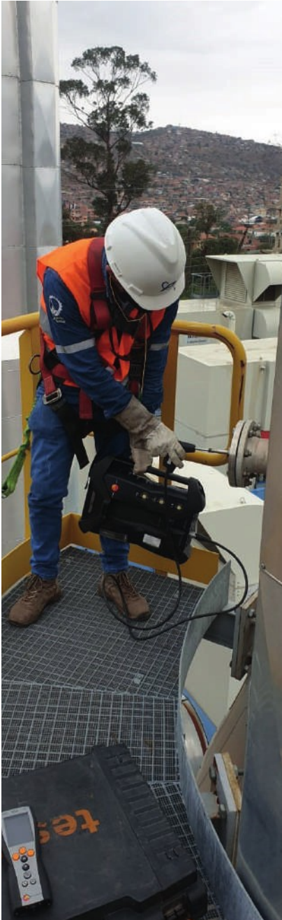
Monitoreo de Gases de Combustión Fuentes Fijas (Central Termoeléctrica Valle Hermoso)
